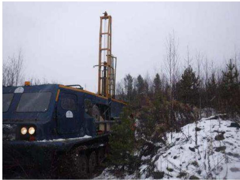
Рисунок 3.1 – Буровая установка УРБ 2А-2 на базе МТЛБ
