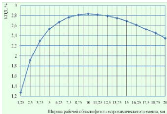
Рис. 6. График зависимости КПД отдельного элемента от ширины рабочей области L (при AM = 1,5 , t = 20\text{ }^{\circ}\text{C} и поверхностной плотности потока излучения 1000\text{ Вт/м}^2 )
