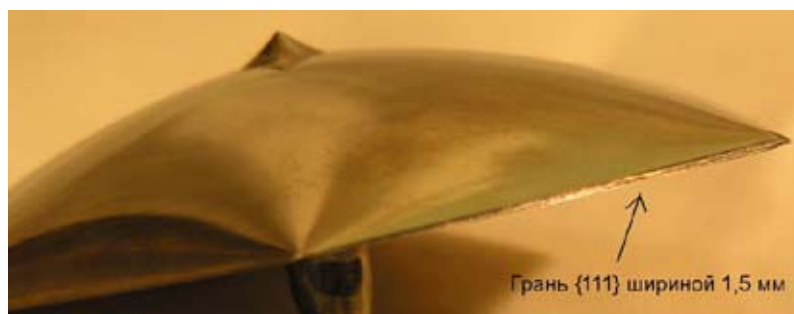
Рис. 5. Выходы граней {111} на фронте кристаллизации монокристалла германия кристаллографической ориентации \langle 111 \rangle
