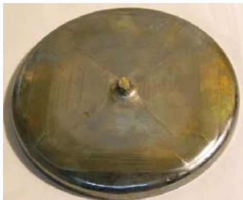
Рис. 3. Верхняя часть выращенного монокристалла диаметром 160 мм кристаллографической ориентации \langle 100 \rangle с сочетанием ограниченных и округлых участков
