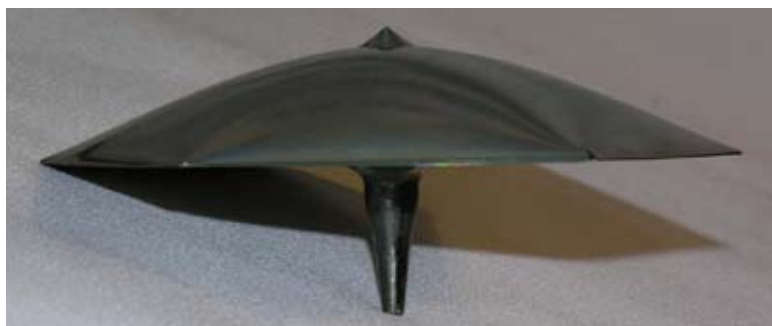
Рис. 4. Форма фронта кристаллизации монокристалла в процессе радиального направления
