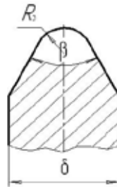
Рис. 4. Скругленный профиль дисковых ножей для исследования влияния их затупления на усилия разрезания трубных образцов
