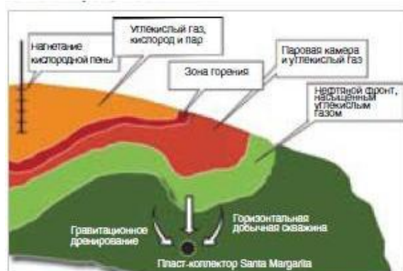
Рис.4 Технология нагнетания кислородной пены
