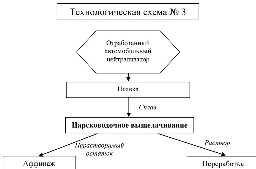
Рисунок 28 – Схема переработки отработанных автомобильных катализаторов №3
