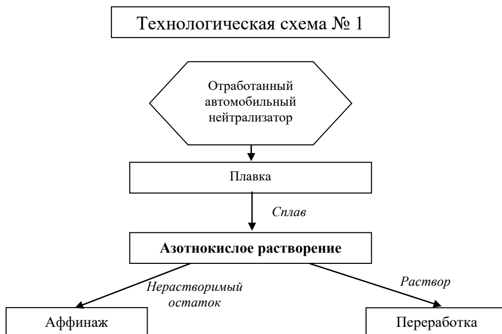
Рисунок 26 – Схема переработки отработанных автомобильных катализаторов №1
