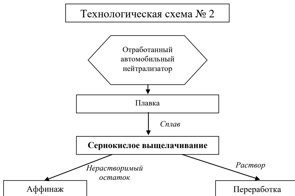
Рисунок 27 – Схема переработки отработанных автомобильных катализаторов №2
