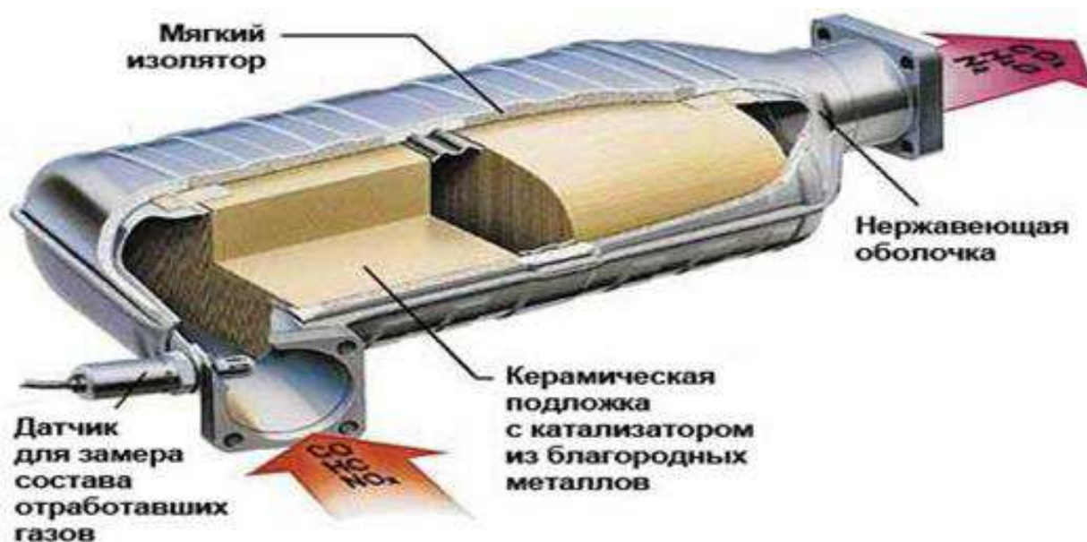
Рисунок 11 – Устройство автомобильного нейтрализатора
