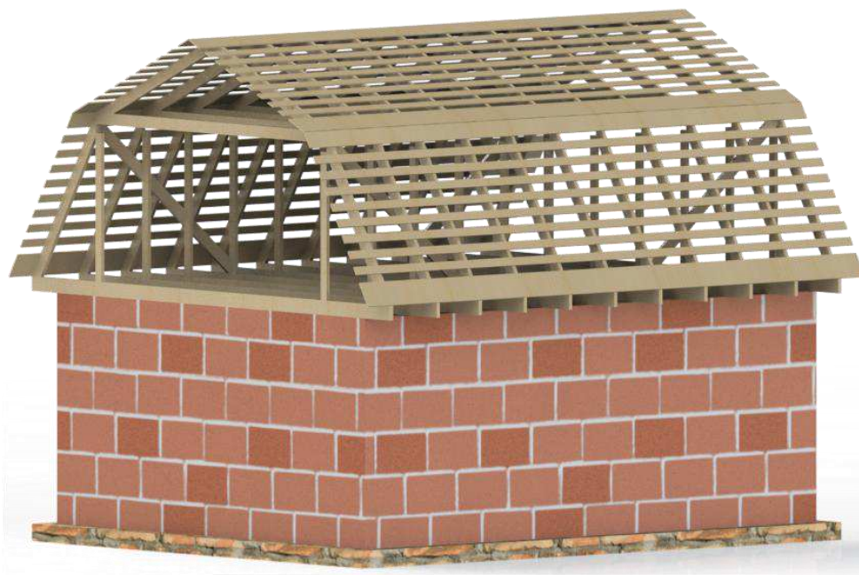
Рисунок 19 – Трехмерная модель мансардной крыши
