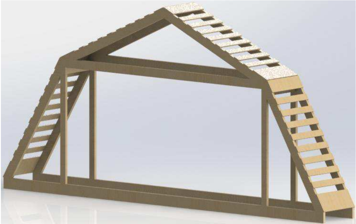
Рисунок 22 – Модель для расчета в ANSYS: вид без профнастила
