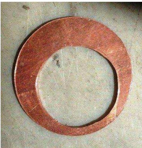
Рисунок 69 – Создание отверстие в заготовке
