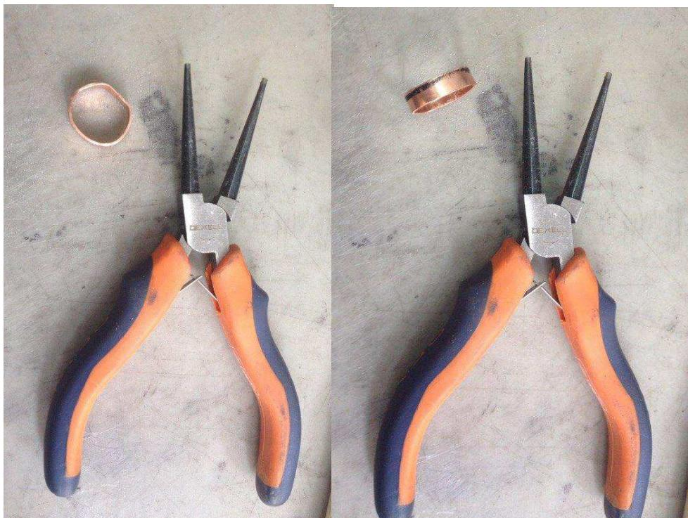
Рисунок 57 – Сведение концов заготовки вместе
