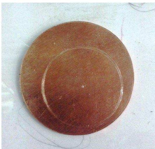
Рисунок 67– Отмеченная окружность на поверхности заготовки
