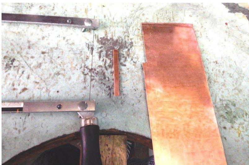
Рисунок 55 – Выпиливание заготовки
