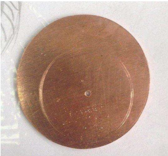
Рисунок 68 – Просверливание отверстия в заготовке
