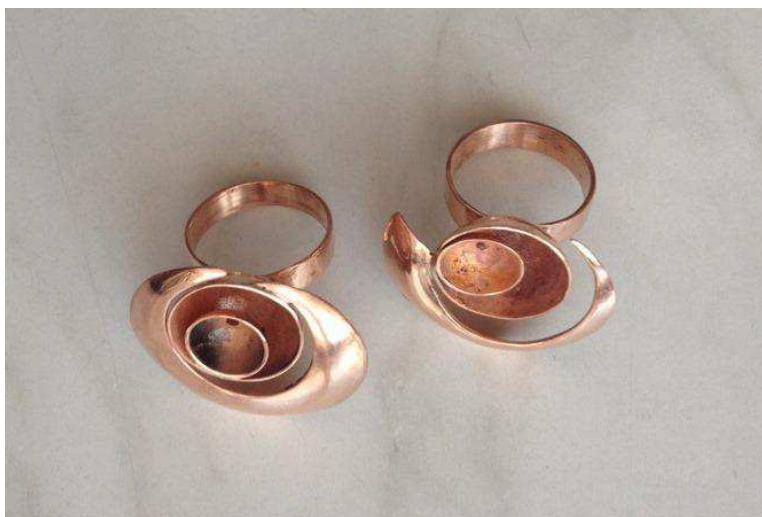
Рисунок 87 – Припаяная шинка к второму и третьему кольцу
