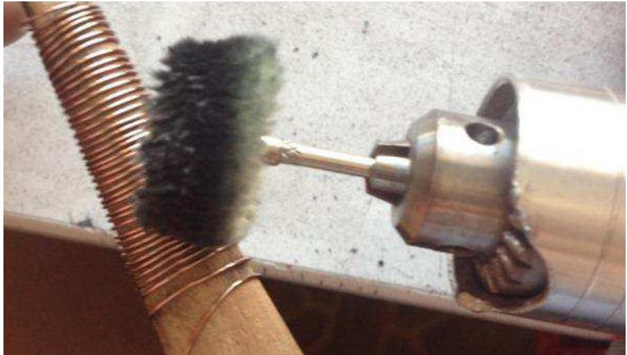
Рисунок 78 – Полировка «пружинки»
