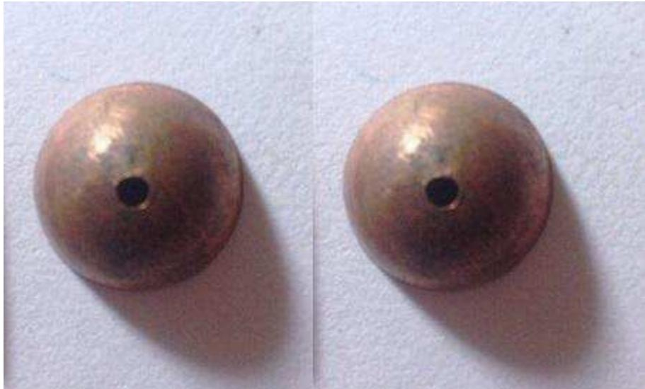
Рисунок 80– Просверленное отверстие в полусферах
