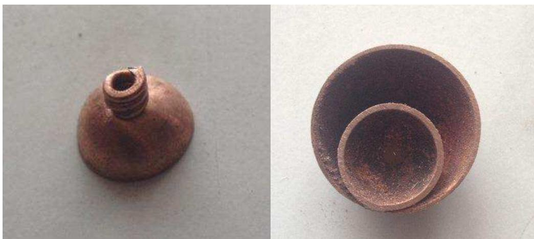
Рисунок 83 – Сборка полусфер для второго кольца
