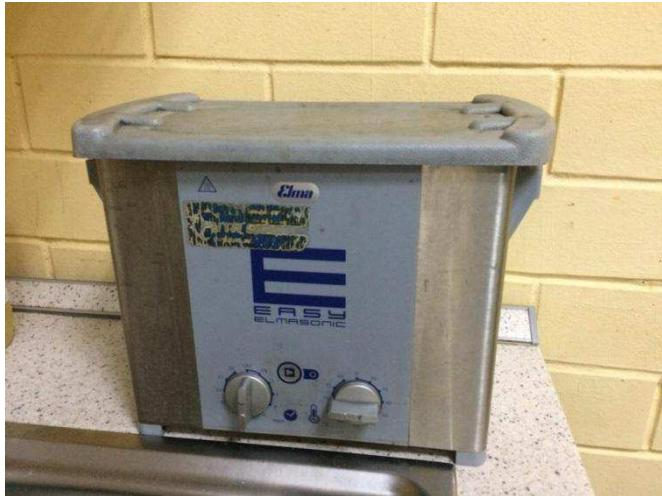
Рисунок 93 – Ультразвуковая ванная
