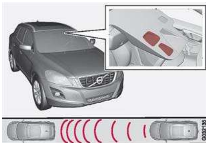
Рисунок 1 - Приемно-выходное окно лазерного датчика
