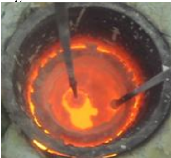
Рисунок 3 – Поверхность электролита после растворения навески глинозема удельной массой 0,48 г/см 2 .
