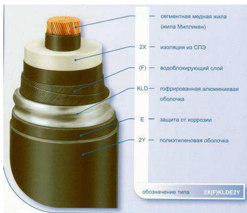
Рисунок 1.7 - Конструкция СПЭ - кабелей с алюминиевой оболочкой
