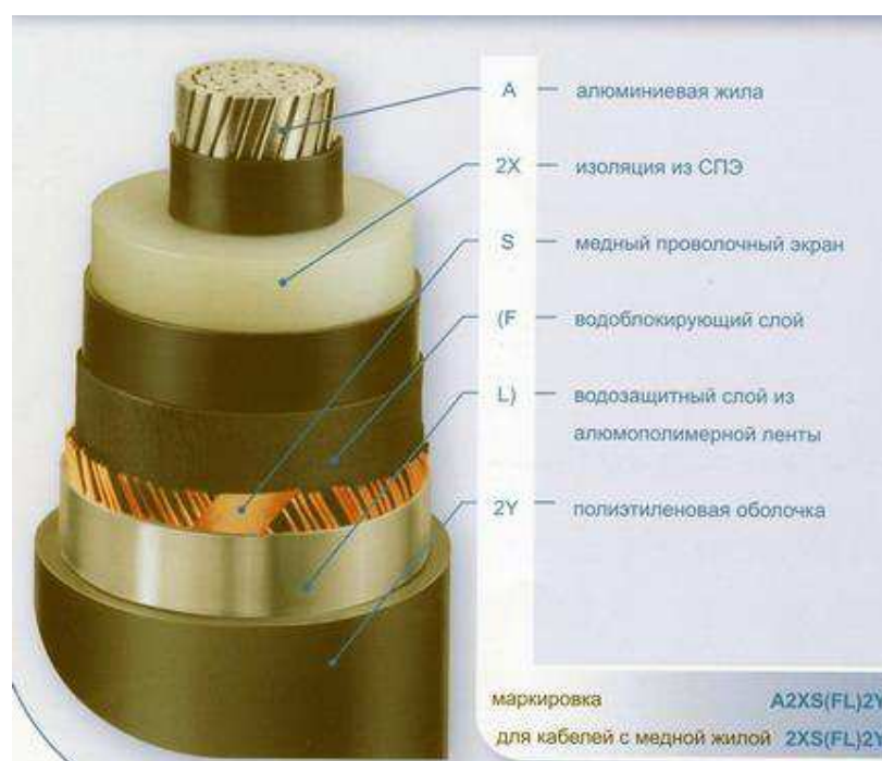
Рисунок 1.5 – Конструкция СПЭ-кабелей с пластмассовой оболочкой
