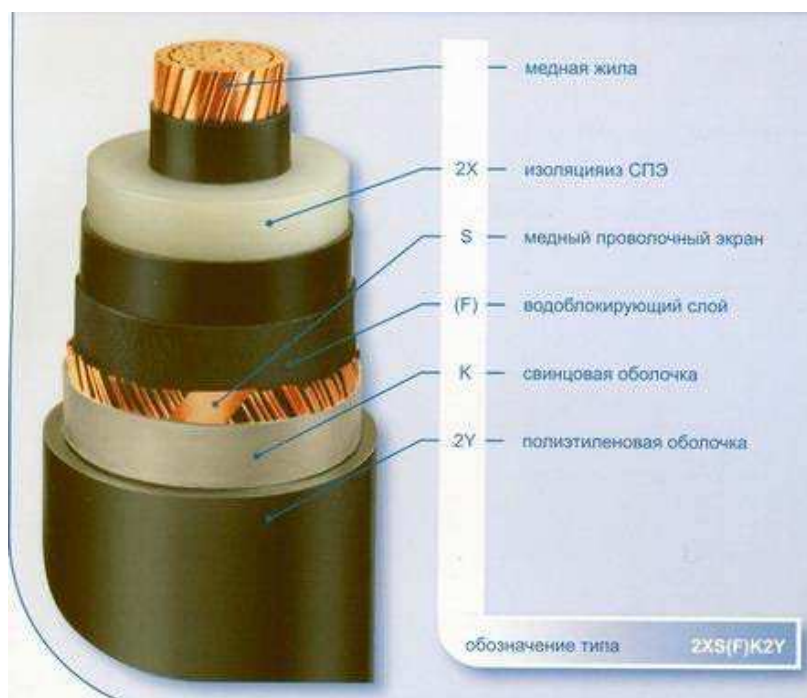
Рисунок 1.6 - Конструкция СПЭ-кабелей со свинцовой оболочкой
