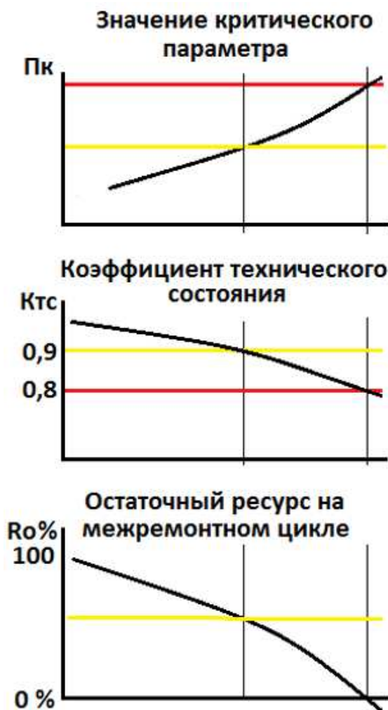
Рисунок 3.16 – Связь параметров состояния со значением «Ктс» и с значением остаточного ресурса оборудования
