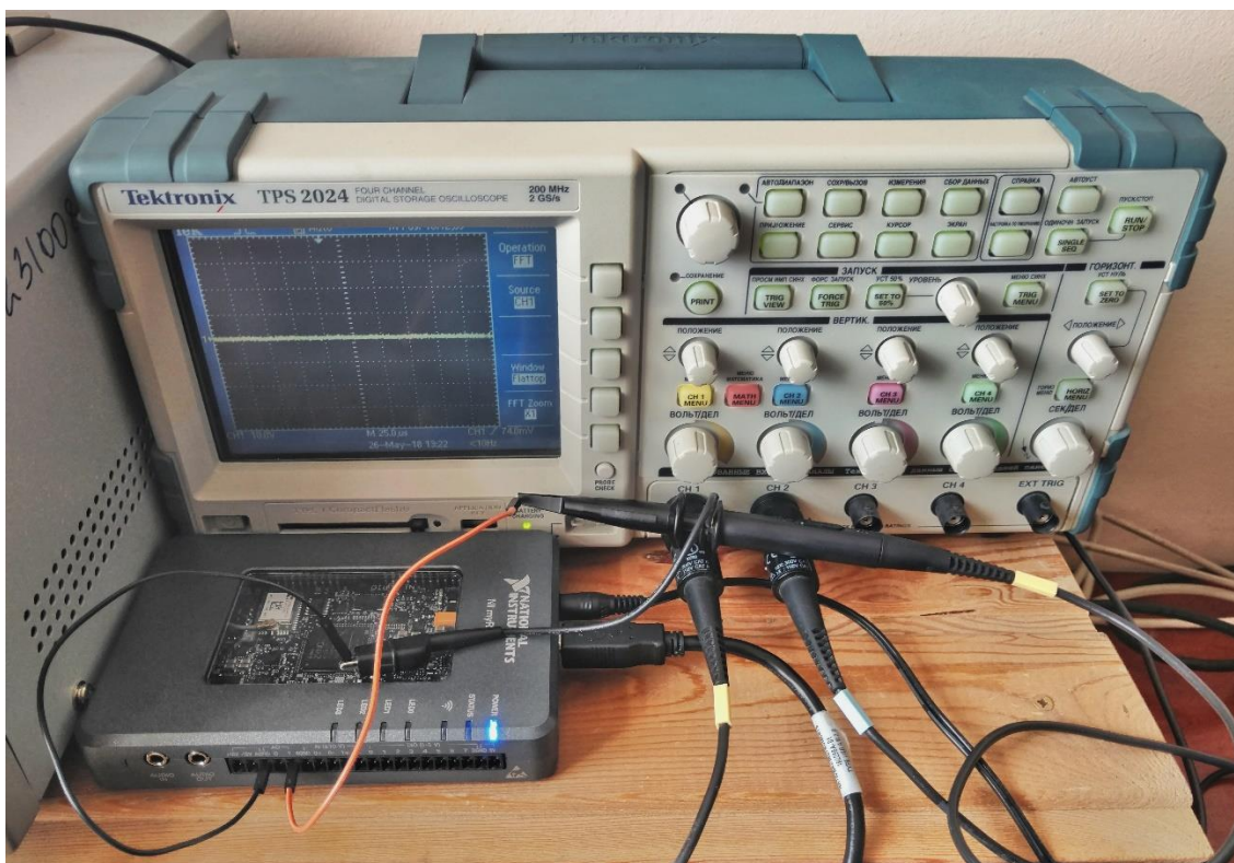
Рисунок 31 – Модернизированный лабораторный стенд для исследования работы генератора
