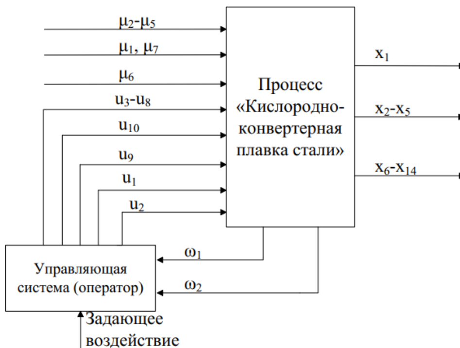
Рисунок 1 – Процесс кислородно-конвертерной плавки с точки зрения теории управления
