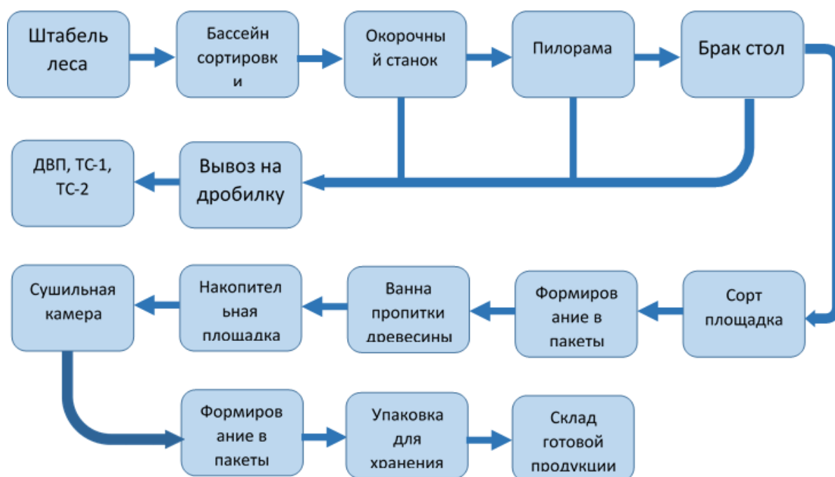
Рисунок 1.3. Схема технологического процесса Лесозавода №1.
