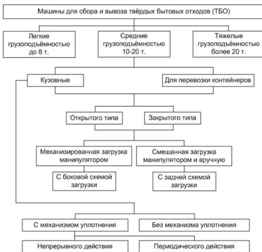
Рисунок 2.4– Классификация машин для сбора и вывоза ТБО
