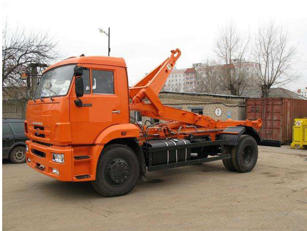
Рисунок 2.15 – Мультилифт МТ-8.36 на базе КамАЗ 4308
