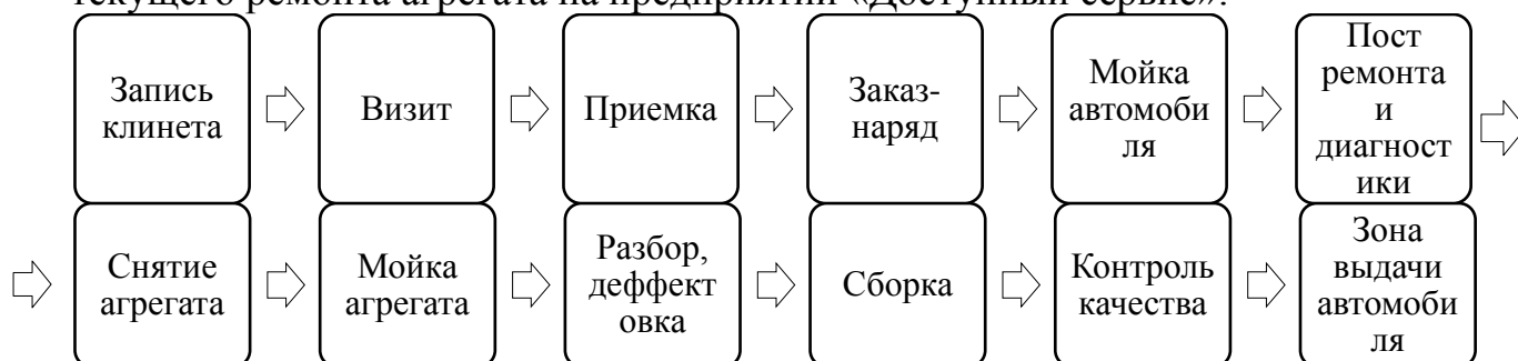
Рисунок 1.5 – Схема процесса выполнения текущего ремонта агрегата
