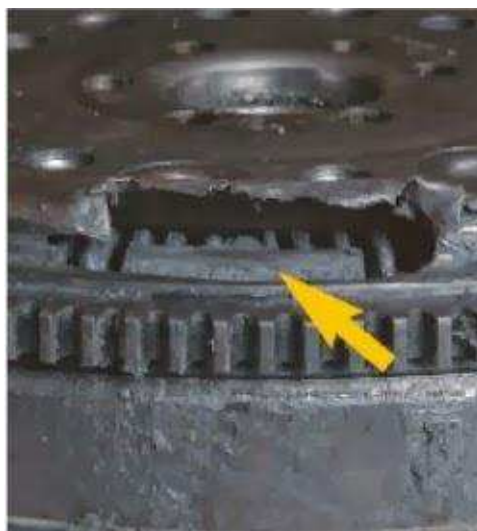
Рисунок 6 – Износ первичного маховика
