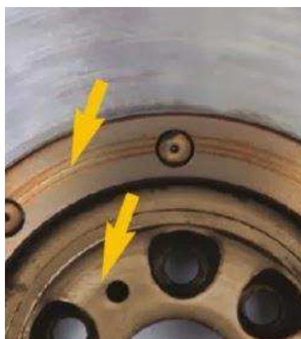
Рисунок 7– Перегрев на внутренней стороне вторичного маховика
