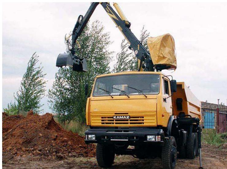
Рисунок 2.10 – Общий вид шламовоза модели 577472
