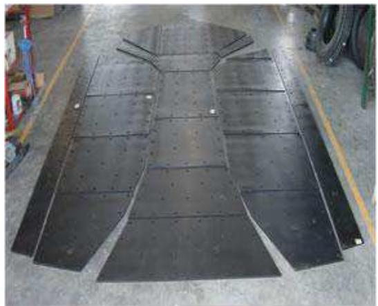
Рисунок 2.15 – Полимерное покрытие кузова
