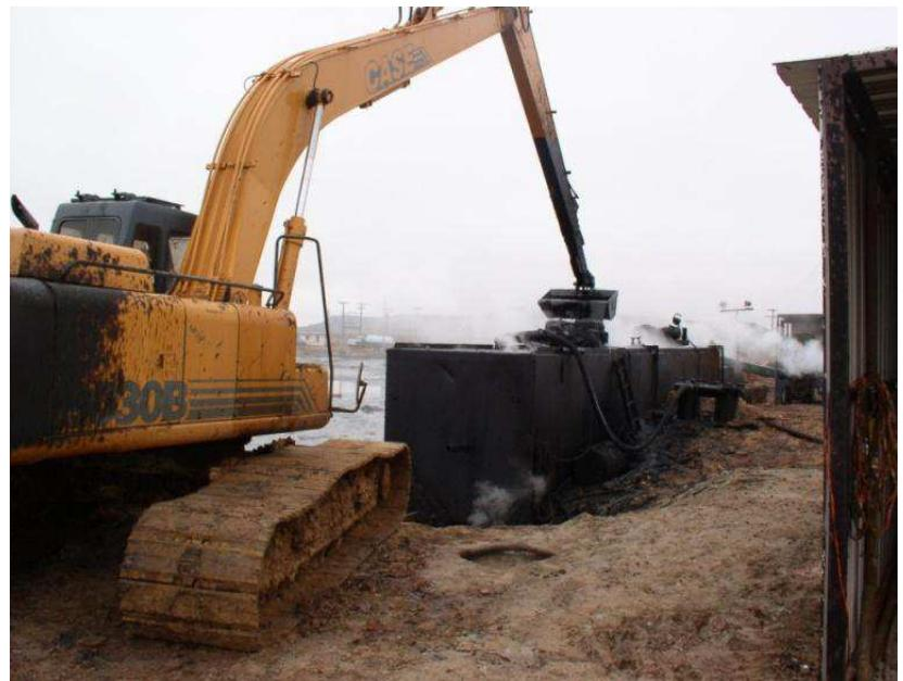
Рисунок 2.6 – Погрузка шлама в специальную емкость
