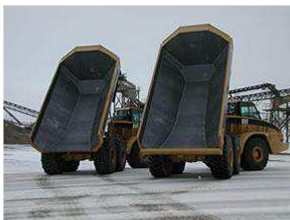
Рисунок 2.16 – Кузов самосвала, футерованный полимерами OKUSLIDE
