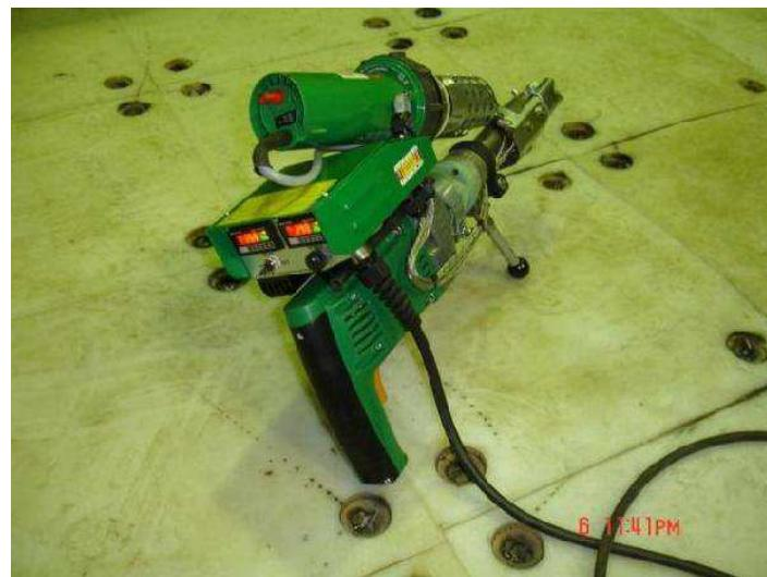
Рисунок 2.19 – Аппарат для заделки швов
