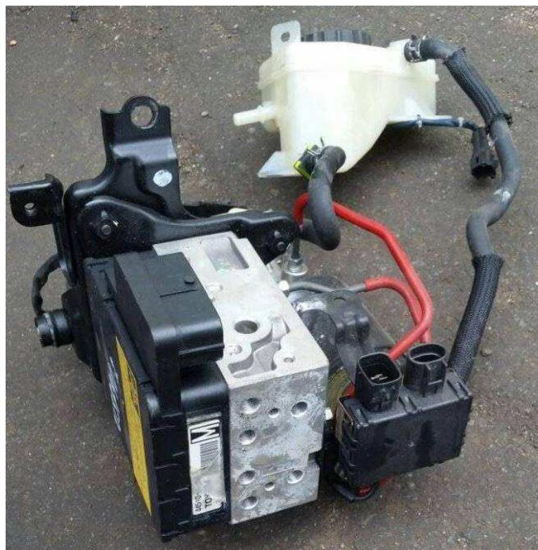
Рисунок 6 – Блок ABS автомобиля Lexus LS460
