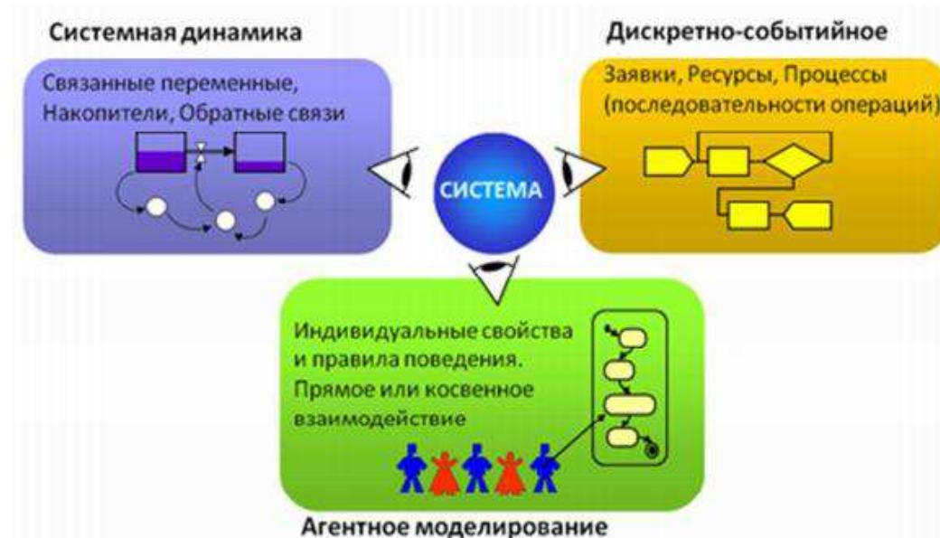
Рисунок 2 – Виды имитационного моделирования
