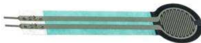
Рисунок 16 – Плёночный тензометрический датчик
