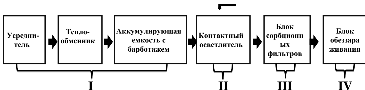
Рисунок 22 - Принципиальная схема процесса очистки
