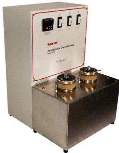
Рисунок 14 – Атмосферный консистометр модель 165АТ
