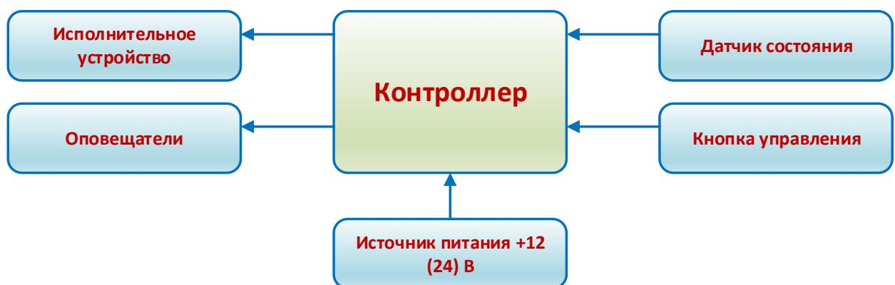
Рисунок 1.1 – Типовая схема СКУД первого класса (в помещении одна дверь)
