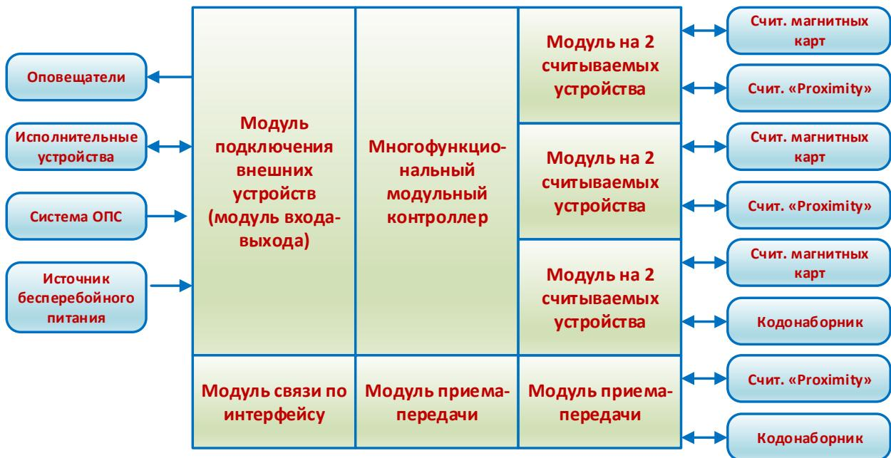
Рисунок 1.3 – Типовая схема СКУД третьего класса
