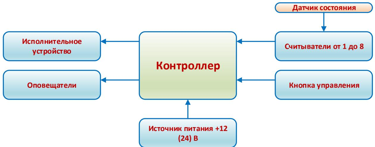
Рисунок 1.2 – Типовая схема СКУД второго класса
