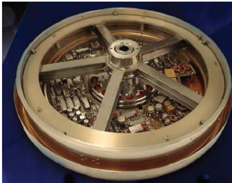
Рисунок 1.3 – Внешний вид двигателя-маховика производства Rockwell Collins
