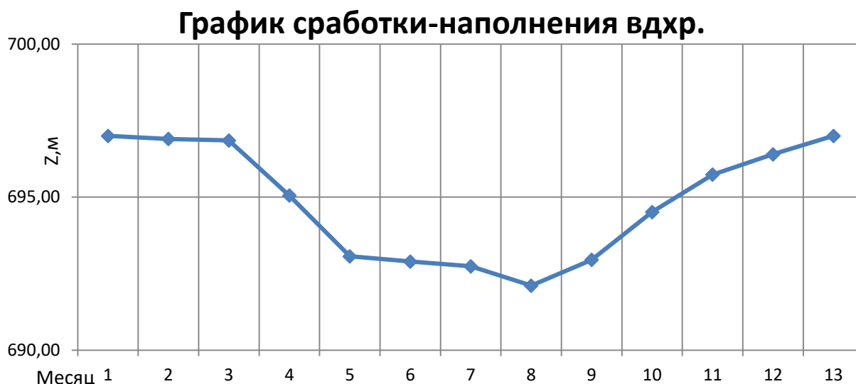
Рисунок 2.5 – График сработки – наполнения водохранилища
