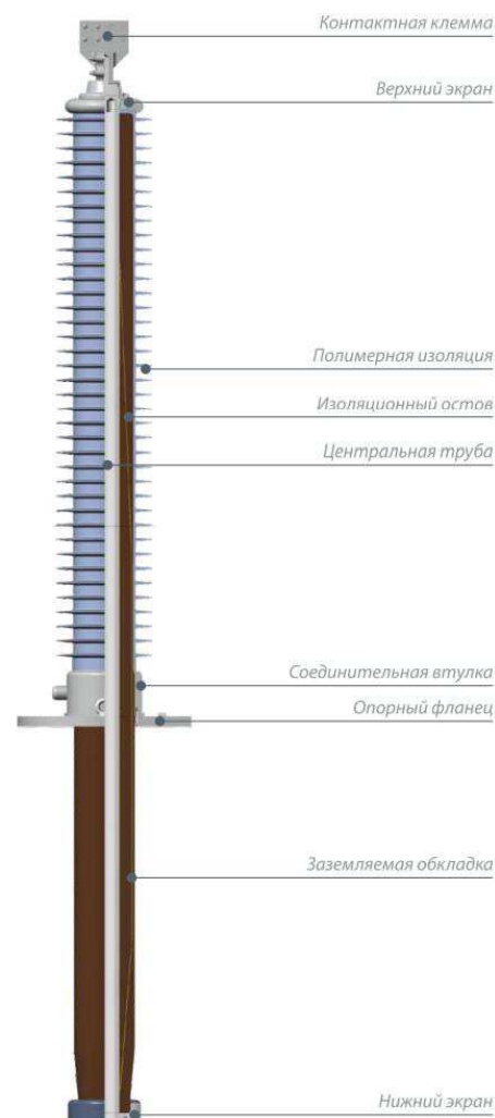
Ввод твердотельный типа RBP, RIP и RIN с полимерной внешней изоляцией
