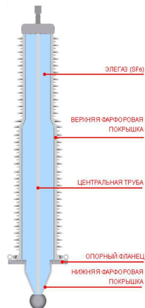
Ввод с внутренней элегазовой изоляцией и внешней фарфорой изоляцией
