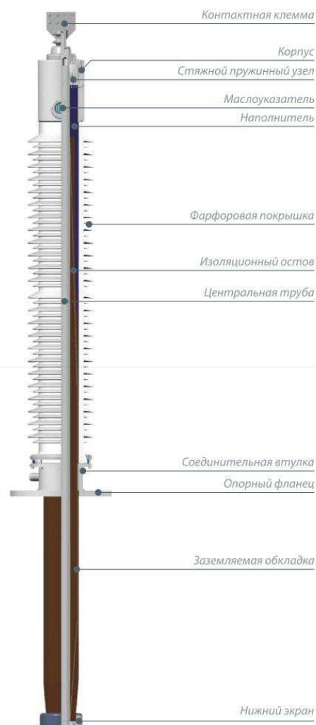
Ввод твердотельный типа RBP, RIP и RIN с фарфоровой изоляцией
