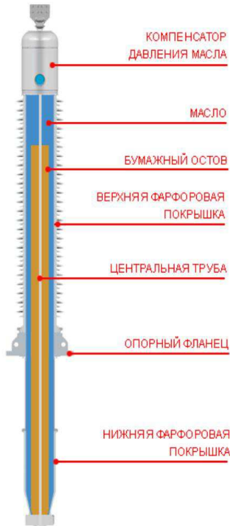
Ввод с внутренней БМИ и внешней фарфоровой изоляцией
