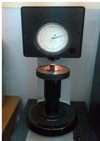
Рисунок 28 – Измерение твёрдости образца на приборе ТК–2.
