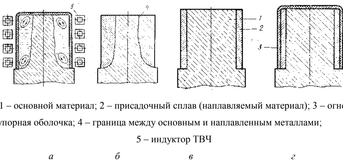
Рисунок 21 – Схема процесса индукционной наплавки в огнеупорной среде:
