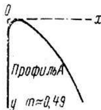
Рисунок 4.1 - Очертание водосливной стенки Кригера-Офицерова
