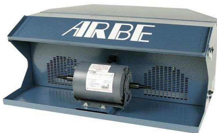
Рисунок 35 – Полировальный станок ARBE DS-204
