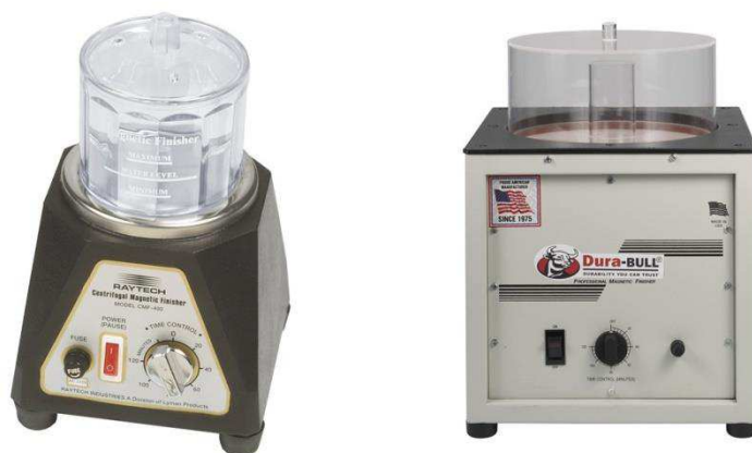
Рисунок 34 – Магнитогалтовка REYTECH CMF-400
