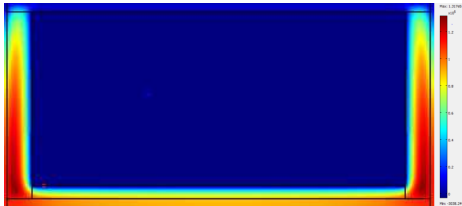
Рисунок 29 - Концентрация радона в ограждающих конструкциях и в воздухе подвального помещения.
