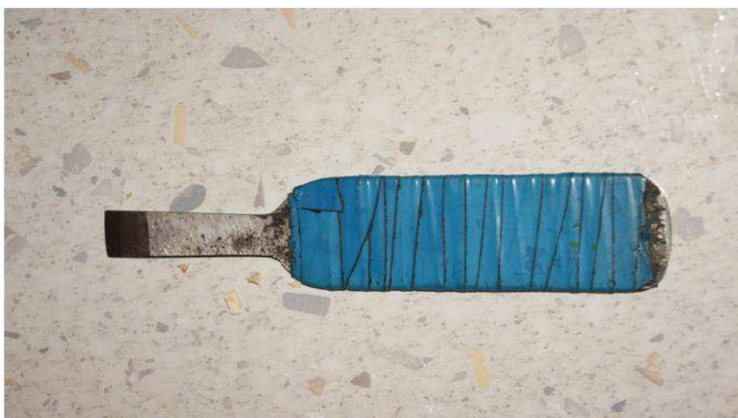
Рисунок 4 – Инструмент для изъятия образцов
