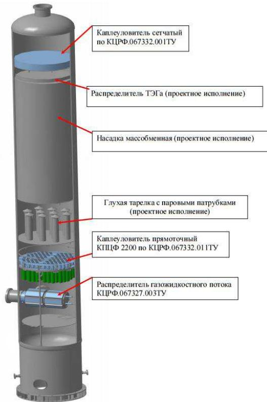
Рисунок 10 – Модернизированный абсорбер С-2801
