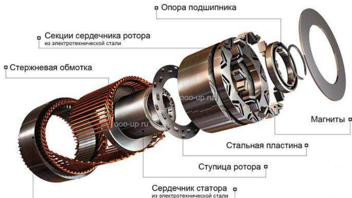
Рисунок 1.1 - Конструкция СДПМ
