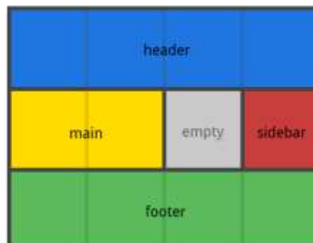
Рисунок 21 – Пример создания структуры веб-сайта с grid-template-areas
