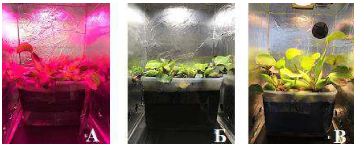
Рисунок 9 – Светоизолированные камеры и культура водяного гиацинта. А – «красный» СИД, Б – «белый» СИД, В – ГЛ (фото автора).
