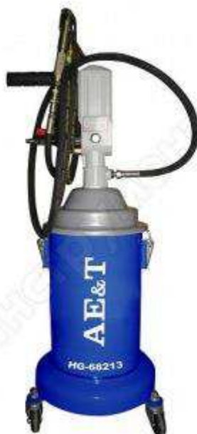
Рисунок 3.7 – Пневматический нагнетатель густой смазки АЕ&Т НГ-68213
