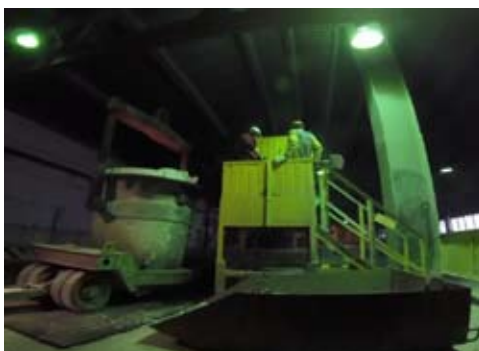
Рис. 5. Отбор проб алюминия на участке удаления шлака из ковшей
