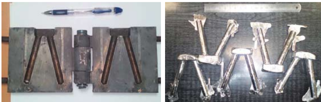
Рис. 3. Изложница и пробы металла для анализа на водород
