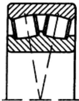
Рисунок 1.6 – Схема двухрядного роликового радиального сферического подшипника
