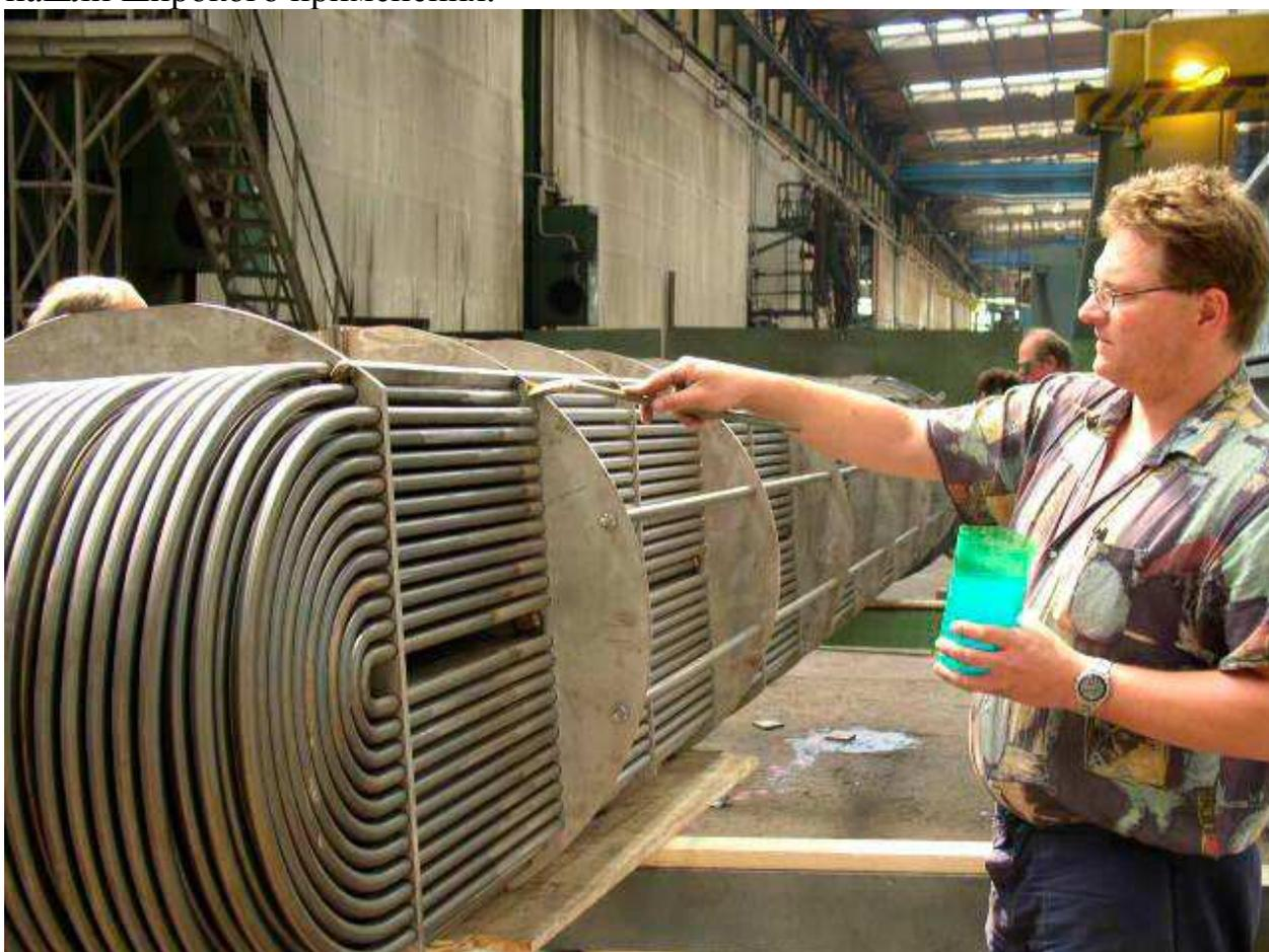
Рисунок 12 - Пучок U-образных труб
