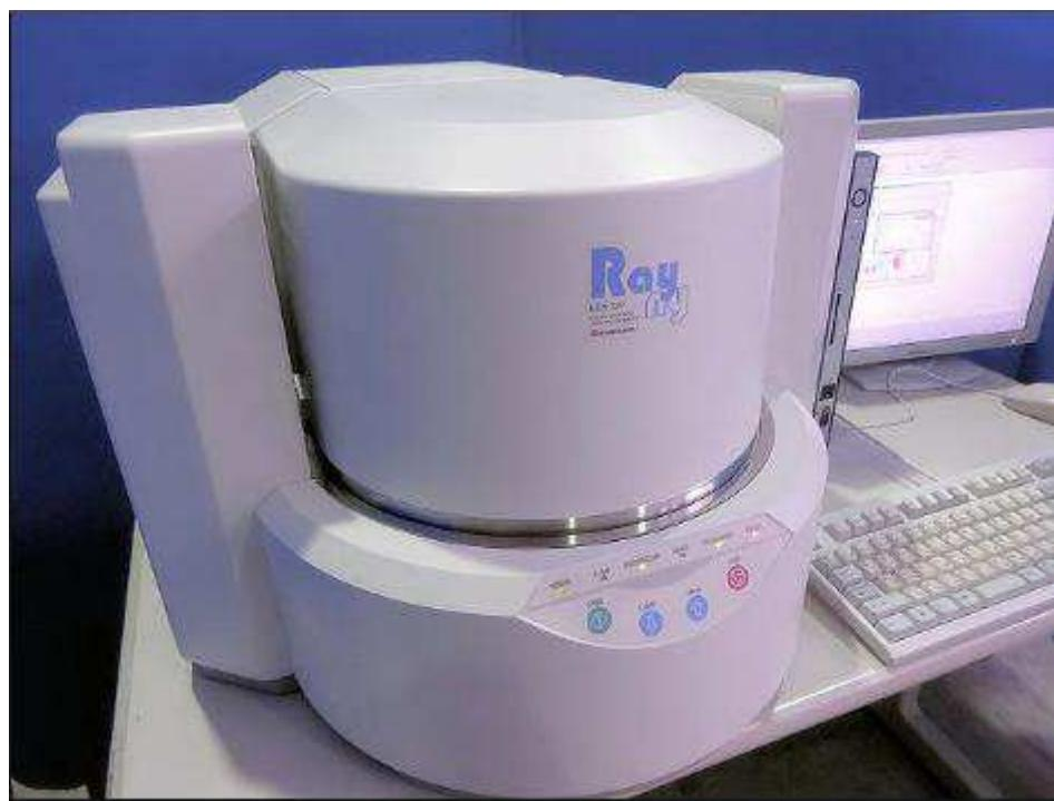
Рисунок 3- спектрометр Shimadzu EDX-860HS
