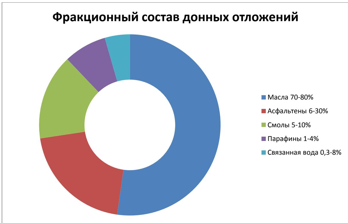
Рисунок 2 – Фракционный состав донных отложений резервуаров
