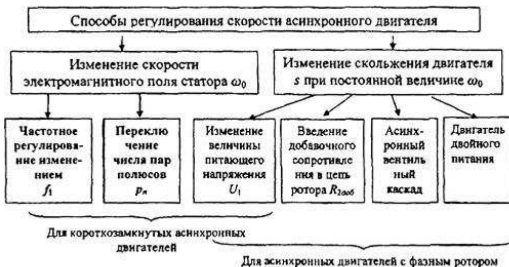
Рисунок 2.1 – Способы регулирования скорости асинхронного двигателя
