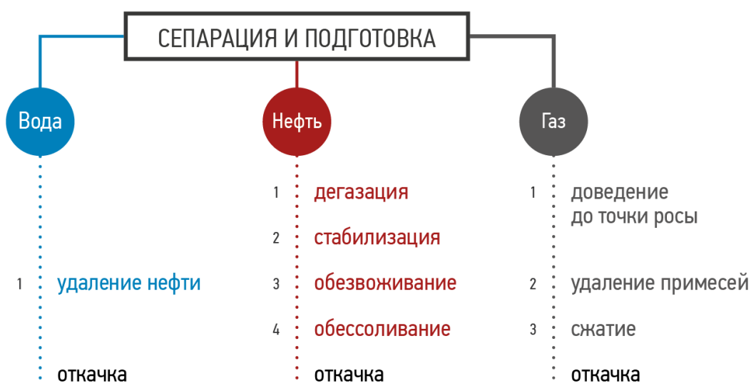
Рисунок 1.1 – Процесс сепарации и подготовки нефти
