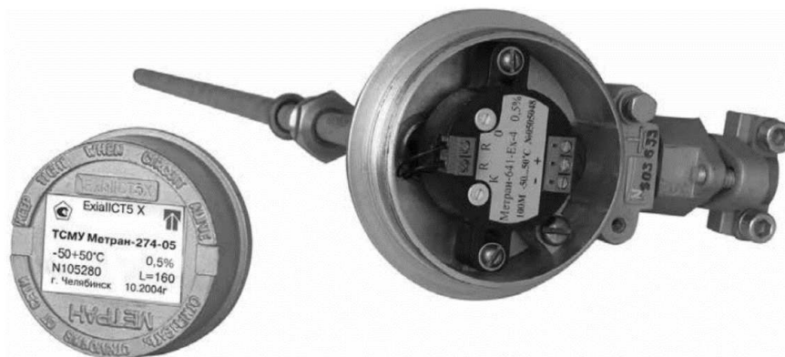
Рисунок 1.14 – Преобразователь температуры Метран 271
