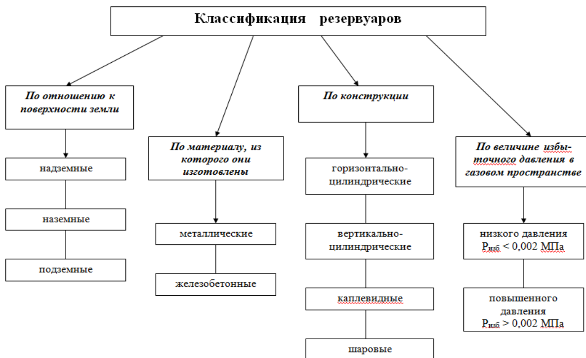
Рисунок 10 - Общая классификация резервуаров
