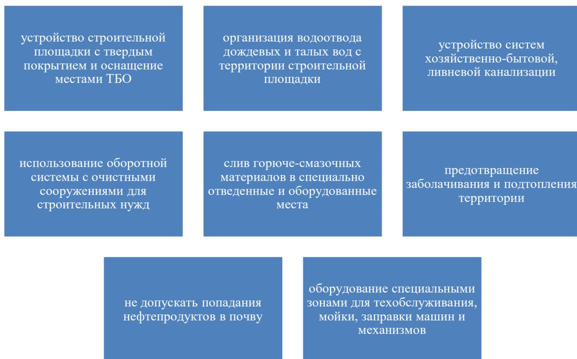
Рисунок 1.6 - Меры для обеспечения нормативного состояния поверхностных и подземных вод при строительстве
