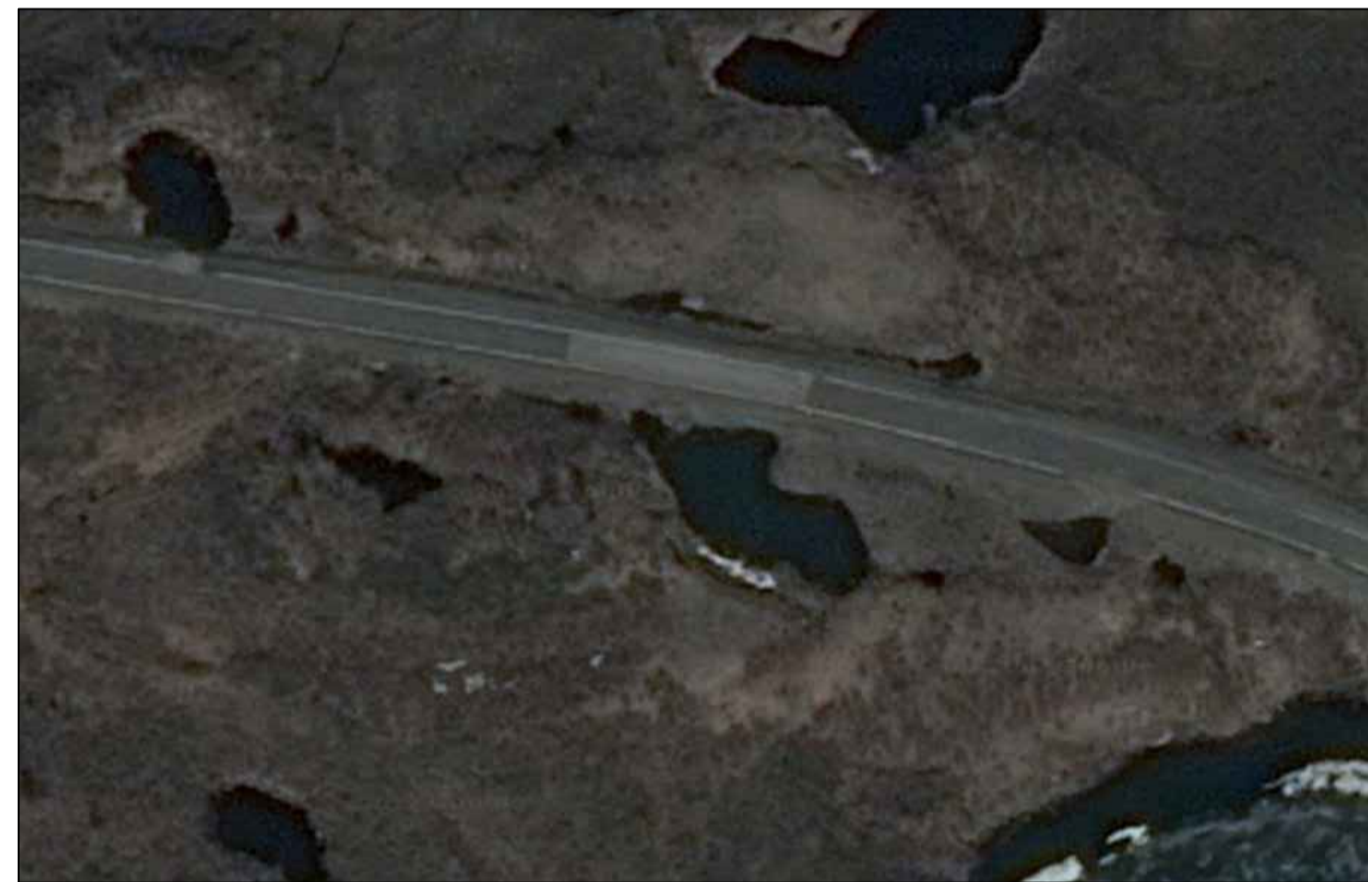
Рис. 2 - Образование термокарстовых озер у подошвы насыпи (фото со спутника)
