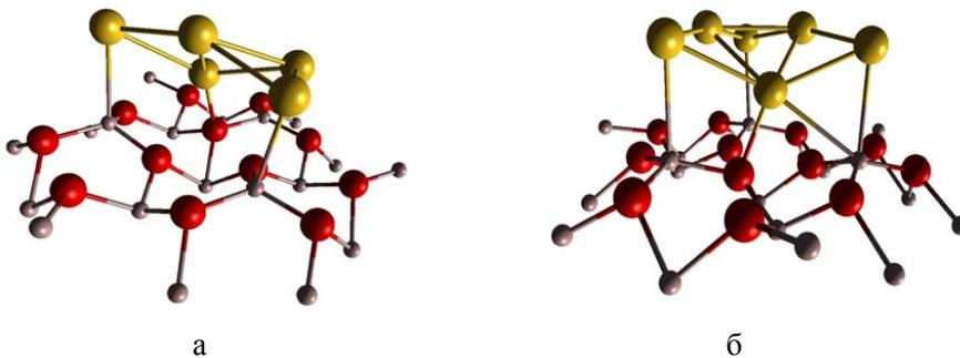
Рис. 3. Оптимизированные структуры комплексов  $\alpha\text{-Al}_2\text{O}_3(0001)/\text{Au}_5$  (а) и  $\alpha\text{-Al}_2\text{O}_3(0001)/\text{Au}_6$  (б)
