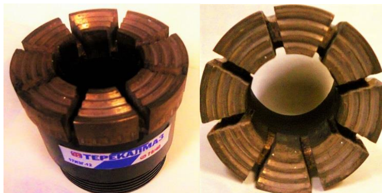
Рис.3. Фото импрегнированной алмазной коронки типа 17ИЗГ–78 АО «Терекалмаз»
