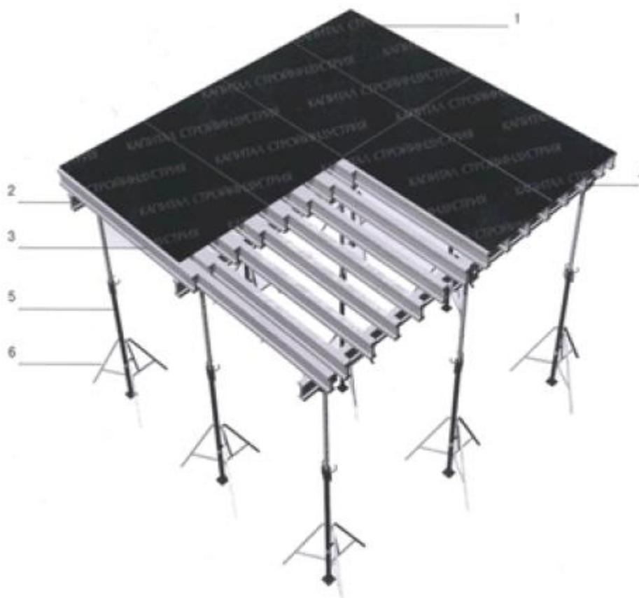
1 - Палуба (фанера ламинированная, толщиной 18 мм); 2 - Продольная балка (БДК 1.1); 3 - Поперечная балка (БДК 1.1); 4 - Вилка универсальная (универилка); 5 - Стойка опорная телескопическая; 6 - Тренога.
