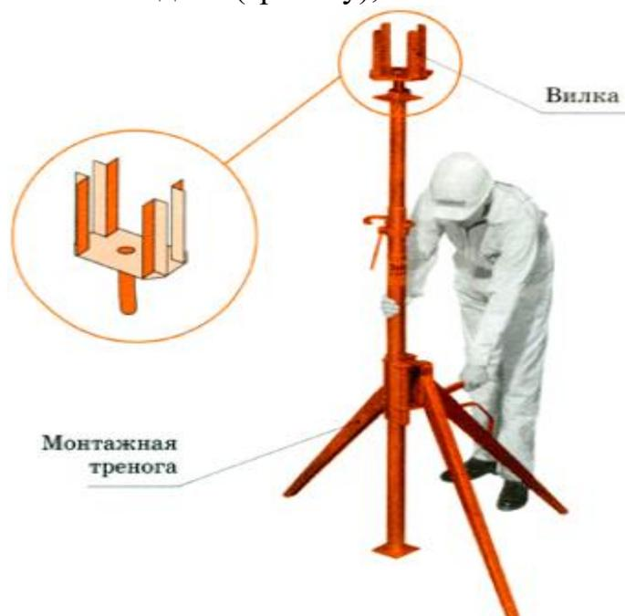
Рисунок 3.1 – Закрепление опорной стойки
