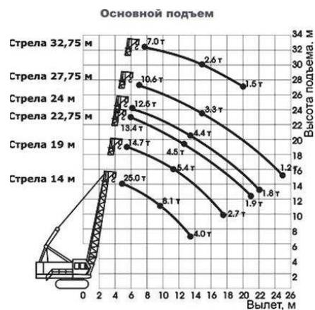
Рисунок 4.3 – Технические характеристики крана ДЭК-251
