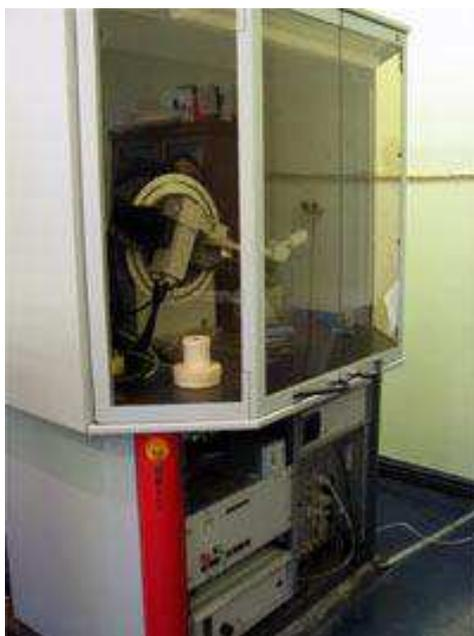
Рисунок 9 – Дифрактометр Bruker d8 Advance
