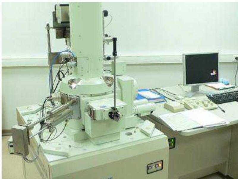
Рисунок 6 – Растровый электронный микроскоп JEOL JSM-7001F
